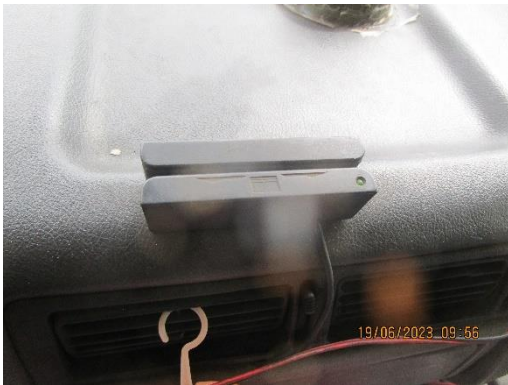
รูปที่ 3.29 การติดตั้งระบบ Global Positioning System (GPS) ที่รถขนส่งสารเคมี
