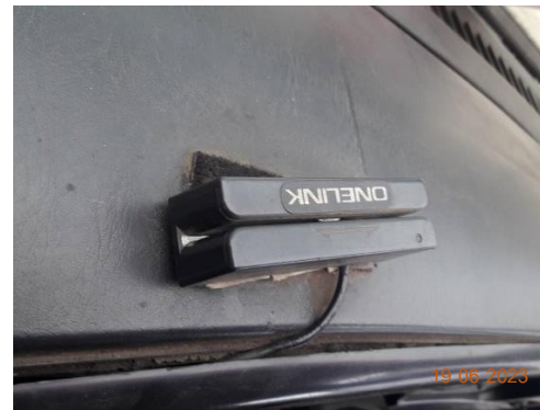
รูปที่ 3.29 การติดตั้งระบบ Global Positioning System (GPS) ที่รถขนส่งสารเคมี
